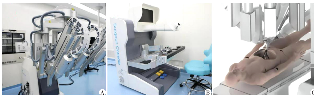
A:手术设备台车;B:配备高清3D显示器的远程控制台;C:可装配蛇形机械臂的手术执行系统。
