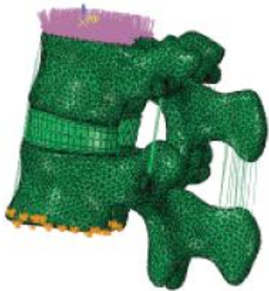
图 1 固定 L5 腰椎底面所有结点平移自由度后的应力施加形式
