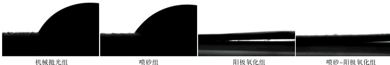
图 2 试件表面接触角
