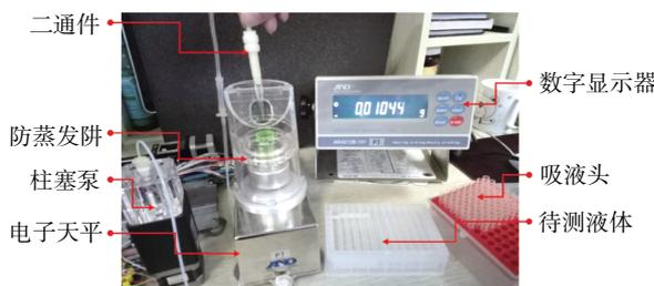
图 3 移液性能测试平台
