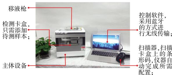
图 12 核酸检测系统总体构成
